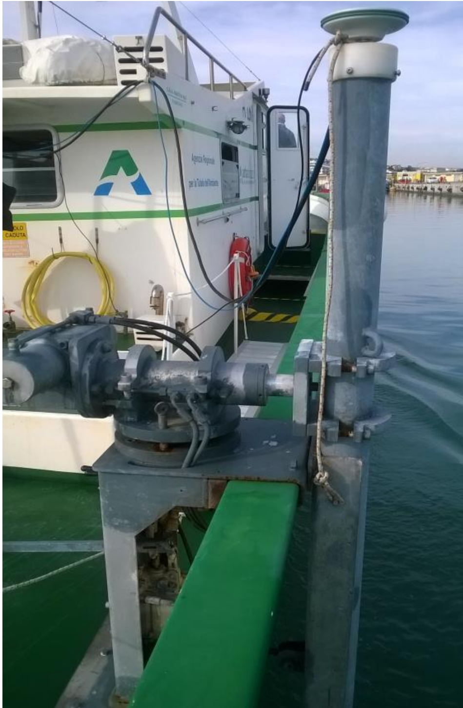
Figura 23. La M/n Ermione dell'ARTA Abruzzo dove è visibile il supporto in metallo immerso in acqua, utilizzato per l'alloggiamento del sistema integrato multibeam/side scan sonar R2SONIC 2022 e della sonda misuratrice della velocità del suono in continuo.
