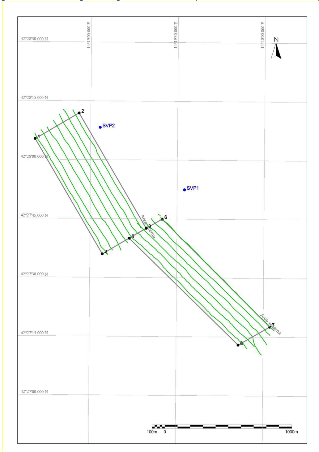
Figura 22. Linee di navigazione e geolocalizzazione dei profili di velocità del suono in acqua.
